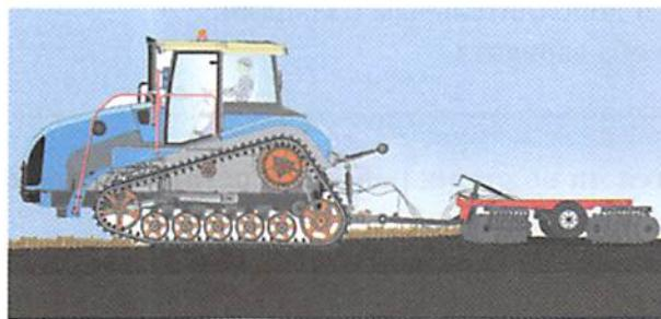
1. Заднего навесного устройства, налаженного по трехточечной схеме.
